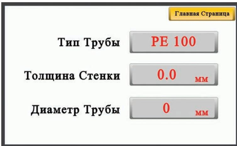
В этом меню Вы можете ввести, тип трубы, которую нужно сварить, толщину стенок трубы и внешний диаметр трубы.
