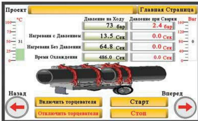
При нажатии значка ВПЕРЕД, соедините трубы одна к одной.
