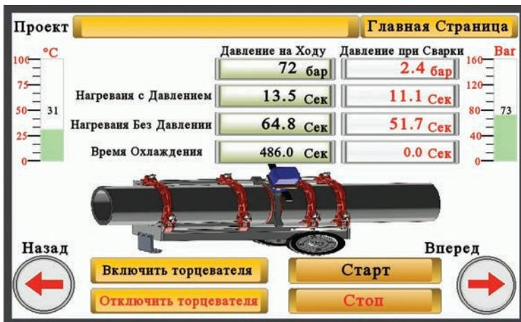
По порядку машинной процедуры, CNC (ЧПУ) сначала посчитает время T1, затем после окончания времени T1, давление снизиться само, в продолжении процесса ЧПУ начинает считать время T2 .
